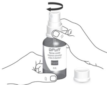
Inserire la pompa con erogatore nella bottiglia ed avvitare completamente in senso orario. Il dispositivo è pronto all'uso.
